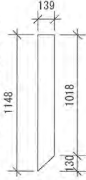
野地板⑦ (下屋根北側)
