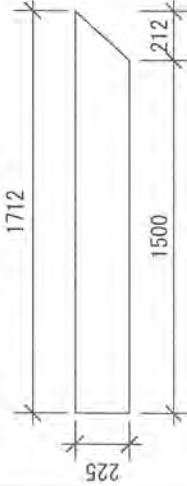
野地板③ (下屋根東側)
